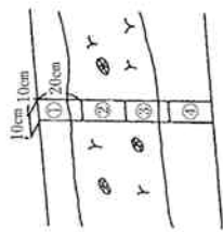
柱状ブロック試料の採取方法
