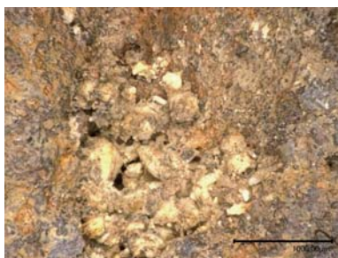
土器表面(実験製作) (マイクロスコープ深度合成像)
